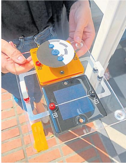
Experimente zu erneuerbaren Energien im neuen energieland-Bildungskoffer: Angetrieben durch ein Photovoltaikmodul setzt ein kleiner Motor eine Scheibe in Gang, die durch Rotation eine optische Illusion zeigt.
