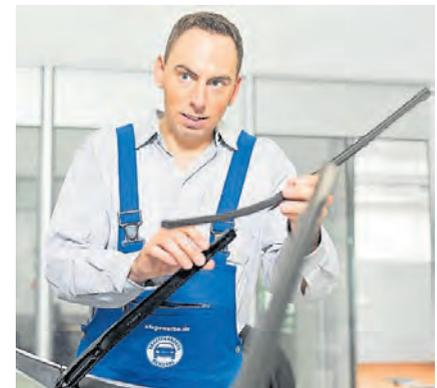
Einmal jährlich sollten die Scheibenwischer ausgetauscht werden – spätestens jedoch dann, wenn sie schmieren, Streifen hinterlassen oder quietschen.
